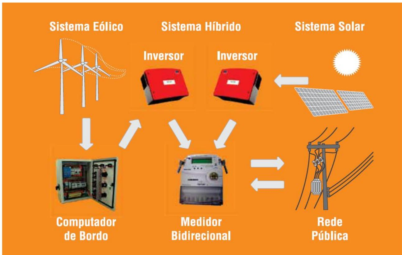
A energia gerada é conduzida a um inversor, que compatibiliza a tensão do sistema com a da rede de energia local, e em seguida é direcionada ao medidor bidirecional, também chamado de medidor inteligente, que controla o sistema de compensação de energia.
